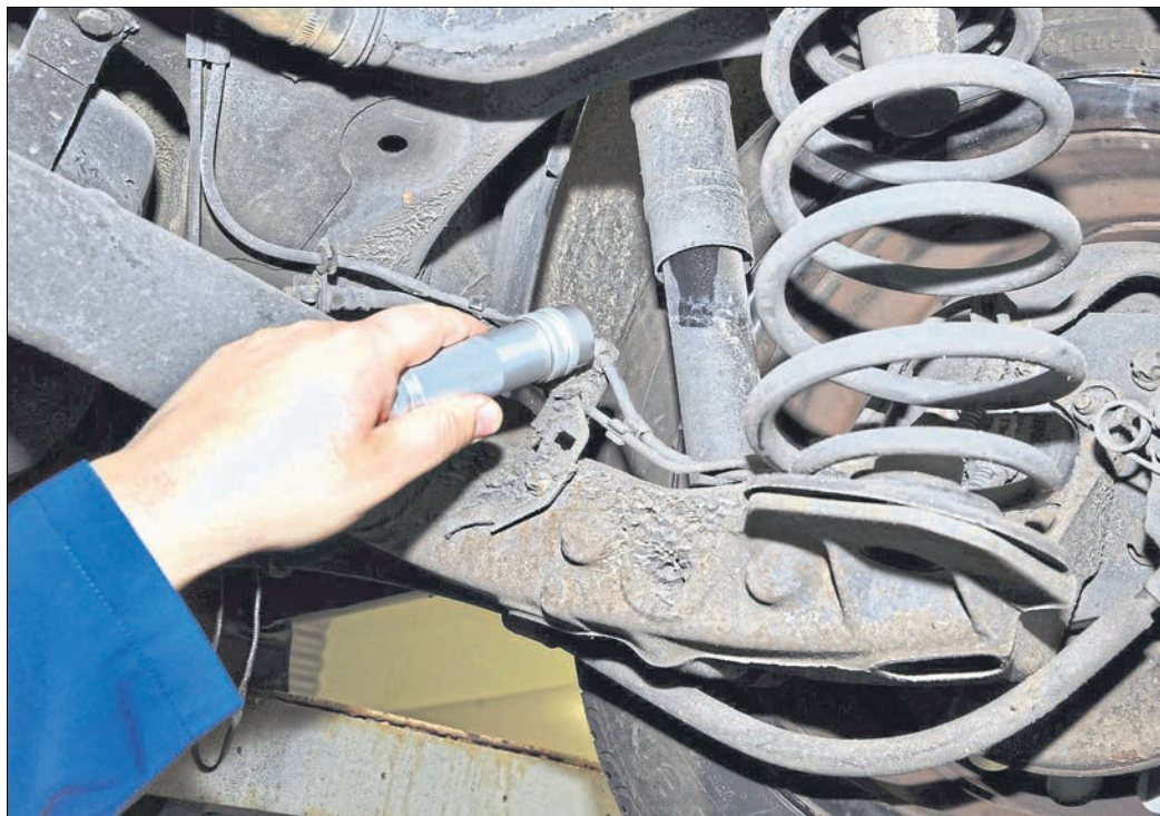
Stoßdämpfer gehören ab einer Fahrleistung von 60 000 Kilometern auf den Prüfstand.
