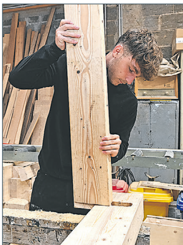
Der Azubi fügt eine Schwalbenschwanzverbindung zusammen.
