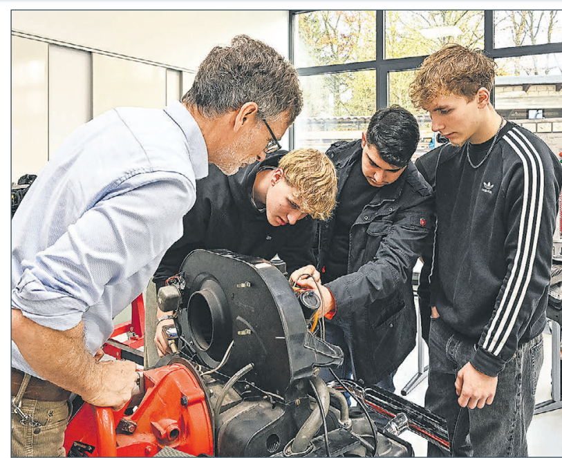
Thomas Dick-Freppon (links) hilft den Schülern beim Kompressionsdrucktest am alten „Käfer“-Motor. Fotos: Schmalenbach
