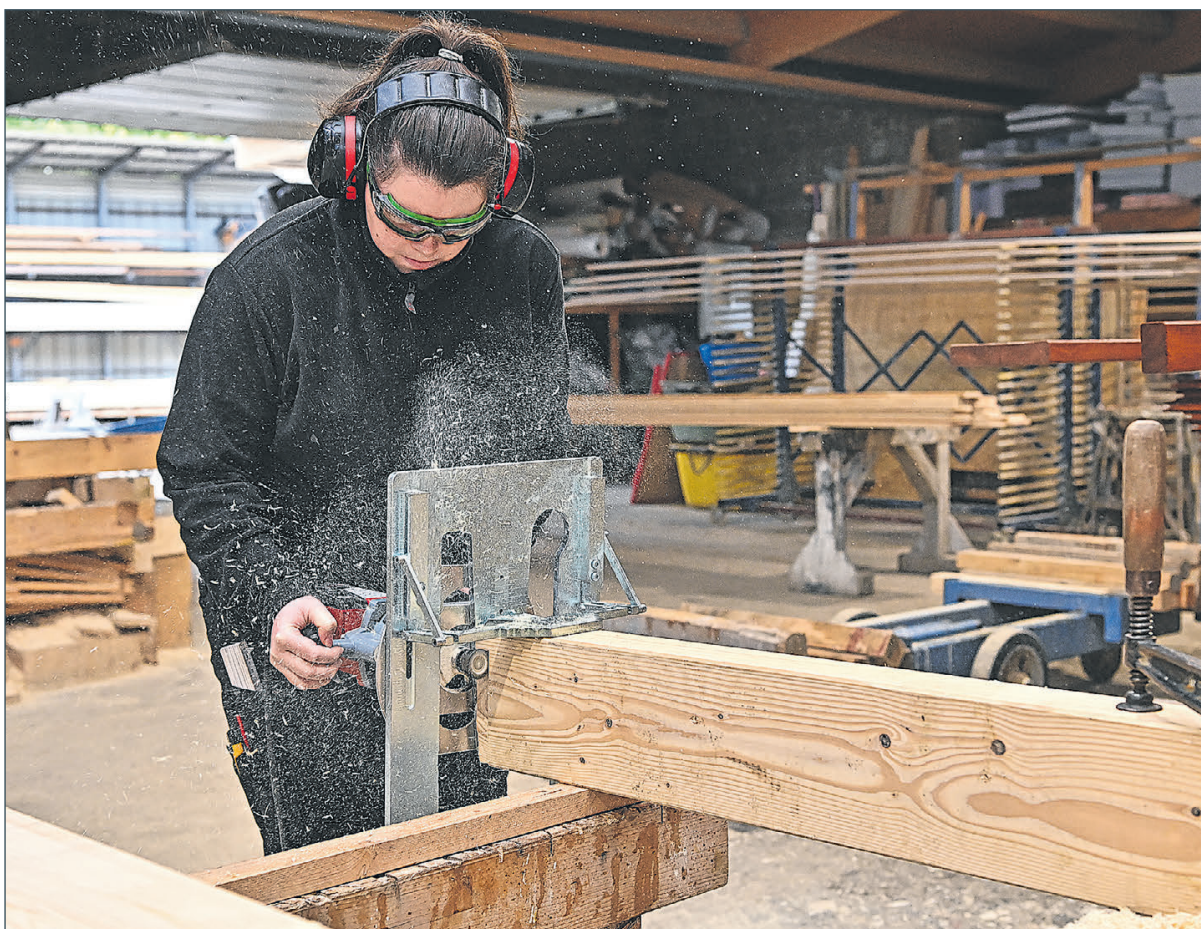
Die 20-Jährige fräst „Schwalbenschwanzverbindungen“ in die Balken, aus denen ein Carport entstehen soll.
