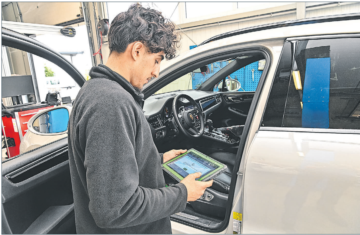
Mit einem Tester geht Mohammad Amin Fayeeg auf die Suche nach einem Problem, das bei diesem Porsche mit der Spannungsversorgung besteht. Fotos: Schmalenbach
