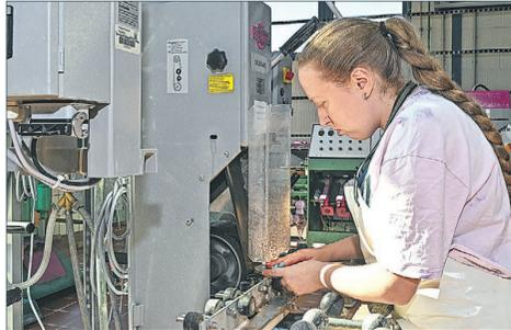
Michelle arbeitet mit viel Gefühl an der Bandschleifmaschine, damit der runde Zugschnitt am Ende die Form eines Eis bekommt.
