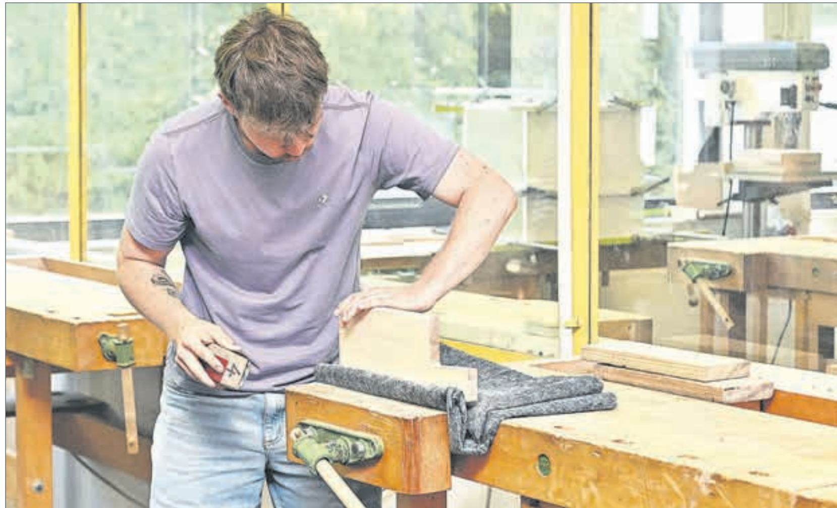
Aaron nutzt das gegenüber den zu Anfang verwendeten Körnungen erheblich feinere 220er-Schleifpapier, um sein Käsebrett vor der Abgabe fertigzustellen.
