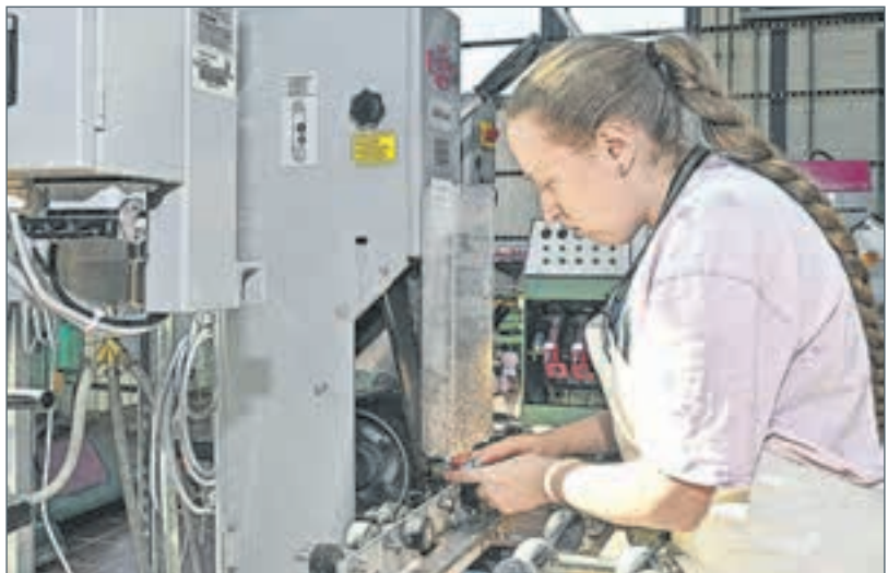
Michelle arbeitet mit viel Gefühl an der Bandschleifmaschine, damit der runde Zugschnitt nicht am Ende die Form eines Eis bekommt.
