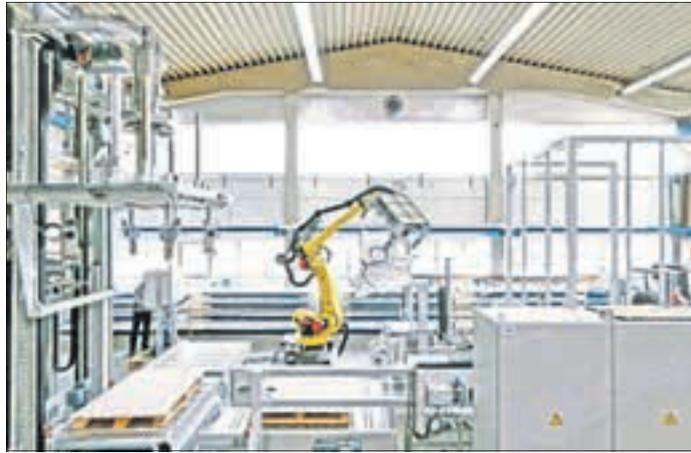
Eine vollautomatische Big Bag Füllstation (links) und eine vollautomatische Big Bag-Entleerstation der EMDE Group, bestehend aus der EMDE Automation GmbH und EMDE Technologies GmbH. Foto: EMDE Group
