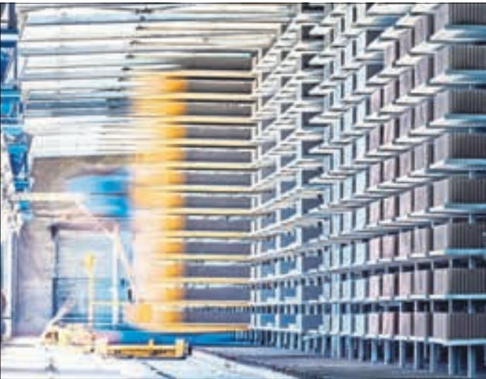
Gute Ökobilanz dank nachhaltiger Produktion: Leichtbetonsteine bestehen aus vulkanischem Bims. Daher müssen sie nicht energieintensiv gebrannt oder ausgehärtet werden.
