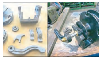
Die Haspel der Seilzugbremse wurde nachgefertigt.
