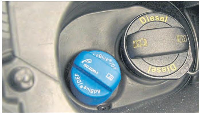
**Mit Inkrafttreten von Euro 6d ist AdBlue bei den meisten Diesel-Pkw in einem eigenen Tank an Bord und muss regelmäßig nachgefüllt werden.**
