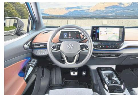
Bedienung und Anzeige im Cockpit des ID.5 konzentrieren sich auf zwei Displays – ein kompaktes hinter dem Lenkrad und ein großes, mittig angeordnetes mit 12-Zoll-Diagonale.
